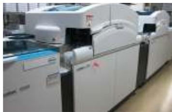
生化学検査、免疫学検査を測定する機械です。
